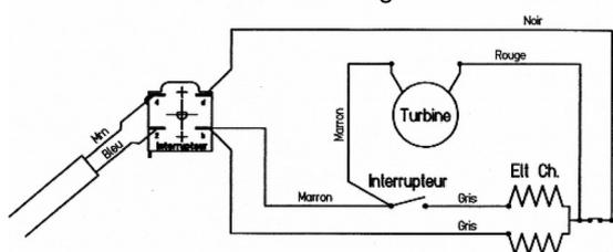
Schéma de câblage avec minuterie
