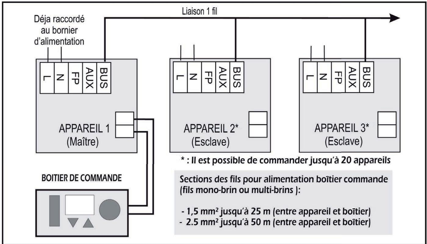
**⚠ Avant toute mise en route du système, il est impératif de finir le branchement de toute l'installation, afin que la reconnaissance du mode de commande soit bien réalisée.**
