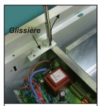
Retirer les deux vis de fixation du bloc de ventilation.
