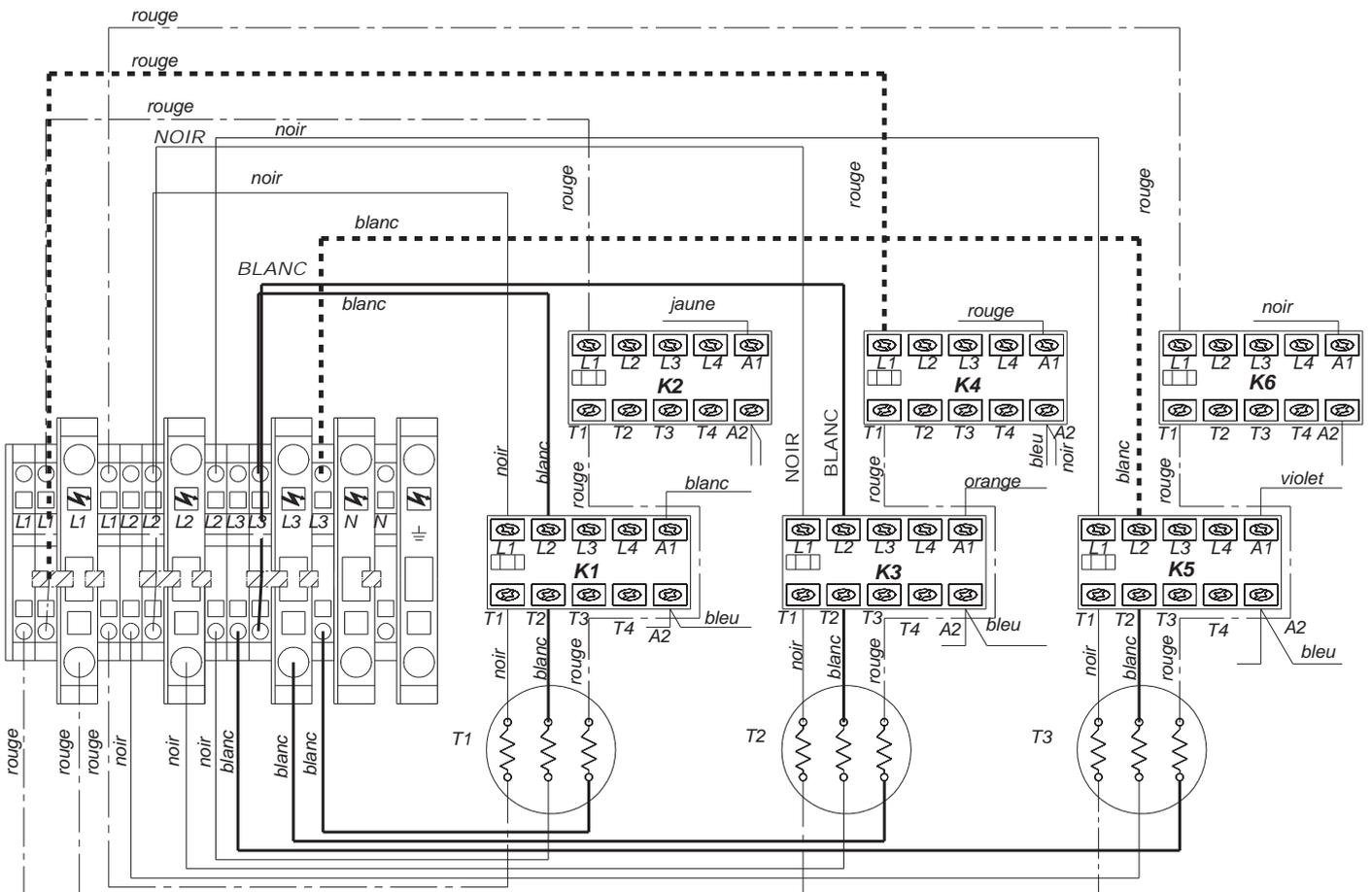
Ajustement à 16 kW ➔ Supprimer les fils noir et blanc de puissance en amont du contacteur K3
