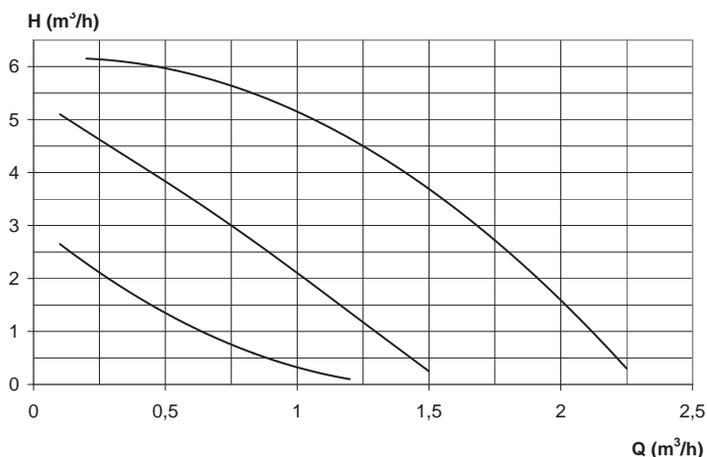
Circulateur 3 vitesses (I, II et III) permettant de l'adapter aux caractéristiques de l'installation.
