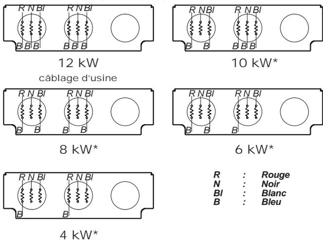
\* Supprimer totalement les liaisons filaires bleues entre le bornier de puissance et les thermoplongeurs comme représenté sur les schémas. Voir § 2.3.1 pour l'accès aux thermoplongeurs.
