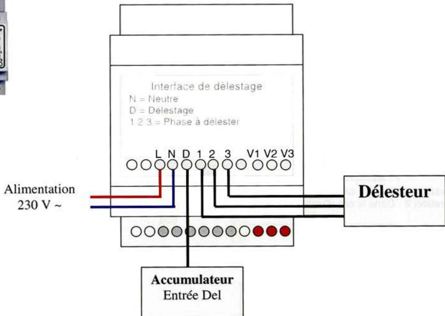
A utiliser avec les délesteurs du marché. Elle assure un délestage par tiers de la puissance par un bus de liaison avec l'accumulateur. Elle permet ainsi délester 1/3, 2/3 ou la totalité de la puissance de l'accumulateur pour le la rendre disponible à d'autres usages afin d'éviter le dépassement de la puissance souscrite.
