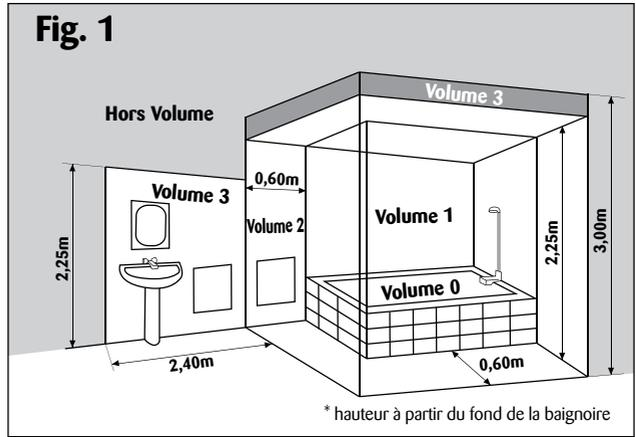
■ L'appareil peut être installé dans le volume 2 ou 3 des salles d'eau (Fig. 1).
