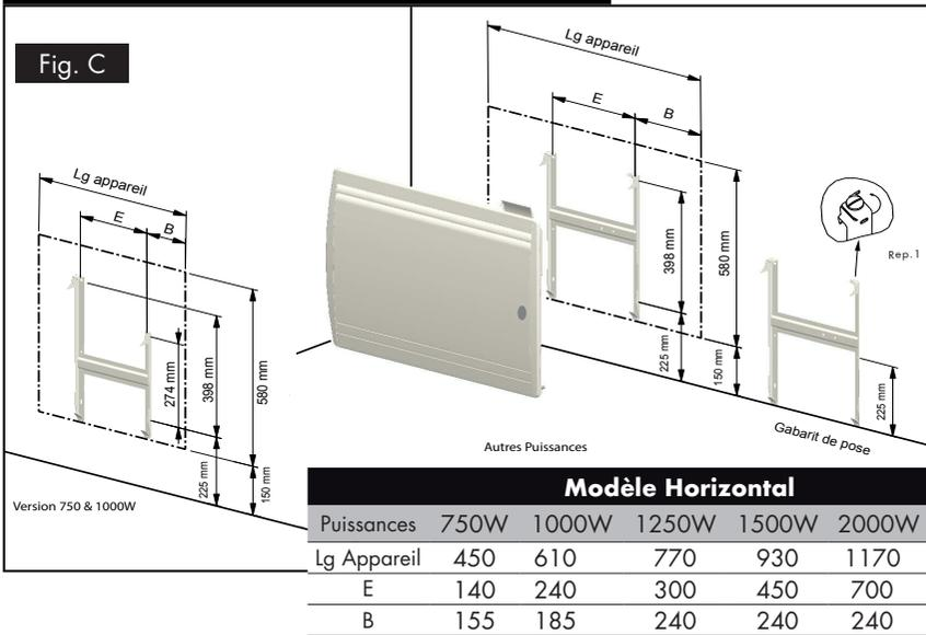
Pour faciliter l'obtention de la cote minimale de 150mm (bas de l'appareil par rapport au sol), il suffit de placer le dossier contre le mur, pattes inférieures posées au sol, pour avoir grâce aux repères de perçage, la fixation inférieure du dossier.
