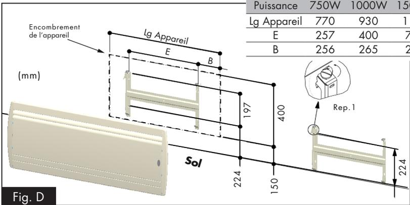
Pour faciliter l'obtention de la cote minimale de 150mm (bas de l'appareil par rapport au sol), il suffit de placer le dossier contre le mur, pattes inférieures posées au sol, pour avoir grâce aux repères de perçage, la fixation inférieure du dossier.
