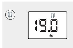
**i** Cette fonction coupe automatiquement l'appareil de chauffage en cas de détection d'une chute brutale de la température dans la pièce (Ex : une fenêtre ou une porte ouverte).
