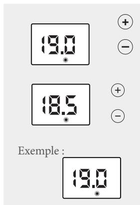
*- Pendant le réglage, un indicateur permet de contrôler mais aussi d'ajuster la température désirée en fonction de son impact sur la consommation.*
