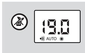
En cas d'absence prolongée, l'appareil diminue progressivement sa consigne de température. Lorsqu'il détecte une présence, il réagit et revient dans le mode de fonctionnement défini par l'utilisateur.
