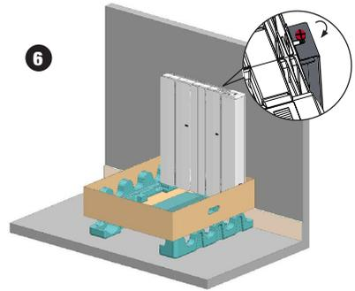
6 - Verrouiller l'appareil sur le dossieret.
