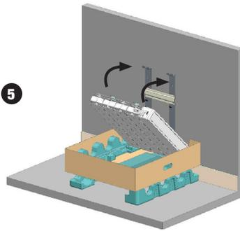
5 - Relever l'appareil et accrocher la chaînette dans son support prévu sur l'arrière du produit.
