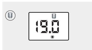
Cette fonction coupe automatiquement l'appareil de chauffage en cas de détection d'une chute brutale de la température dans la pièce (Ex : une fenêtre ou une porte ouverte).
