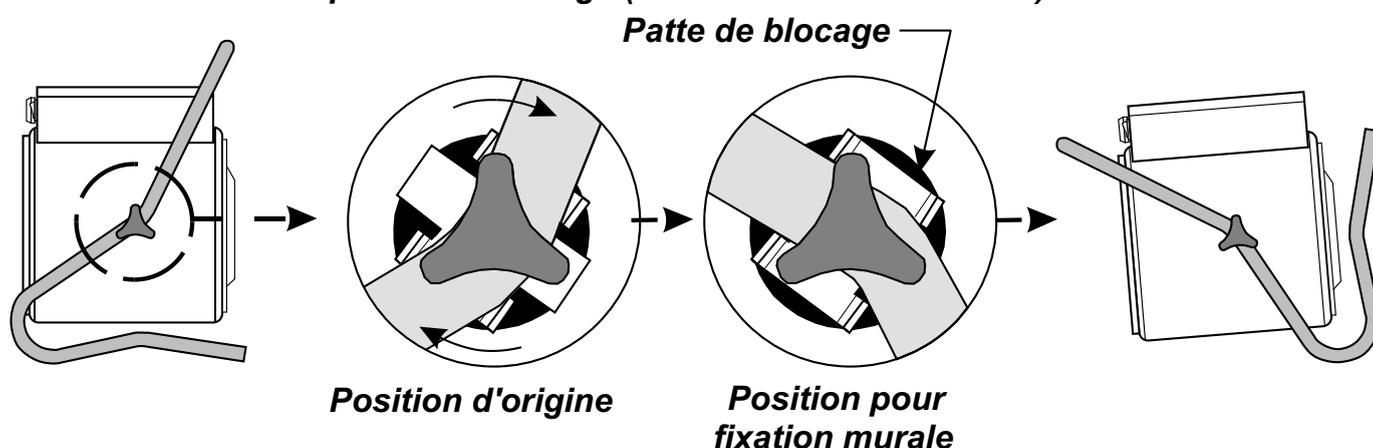
Se servir du pied comme gabarit de traçage. Utiliser des vis appropriées au support choisi.
