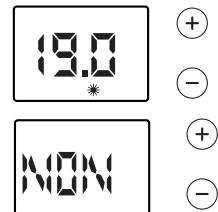
**i** Permet de bloquer l'accès aux réglages de l'appareil afin d'empêcher toute modification intempestive.
