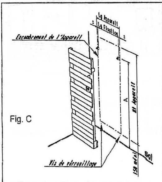
L'espace minimum 150mm entre le sol et le bas de l'appareil doit être respecté. Un espace de 100mm minimum doit être laissé de chaque côté de l'appareil (Fig. C).
