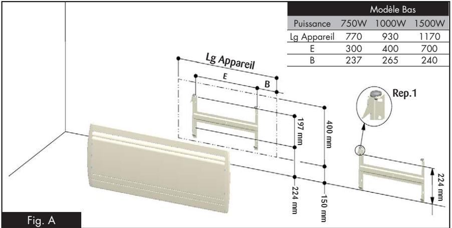
■ Pour effectuer cette opération, ôter le dossier de l'appareil à l'aide d'un tournevis en agissant sur les 2 pattes. (Rep. 1 Fig. A, B & C).
